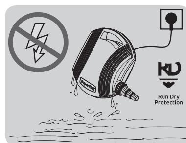
In het geval van oververhitting van de pomp heeft deze een thermische beveiliging tegen overbelasting. In het geval van oververhitting van de motor, schakelt het apparaat automatisch de pomp uit. De afkoeltijd bedraagt ongeveer 15 tot 20 minuten, dan wordt de pomp automatisch weer ingeschakeld. Als de motorbeveiliging is geactiveerd, is het essentieel te onderzoeken wat de oorzaak is van de oververhitting en deze op te lossen.
