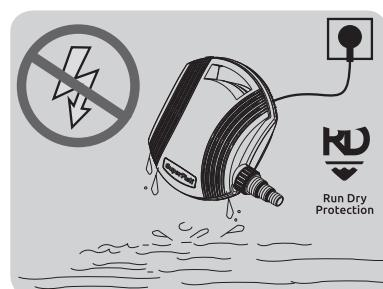
Die Pumpe ist mit einem thermischen Motorschutzschalter ausgestattet. Im Falle einer Überhitzung schaltet der Motorschutzschalter die Pumpe automatisch ab. Die für die Abkühlung erforderliche Zeit liegt bei ca. 15-20 Min.; danach schaltet sich die Pumpe automatisch wieder ein. Wenn sich der Motorschutzschalter eingeschaltet hat, muss auf jeden Fall die Ursache gefunden und beseitigt werden.
